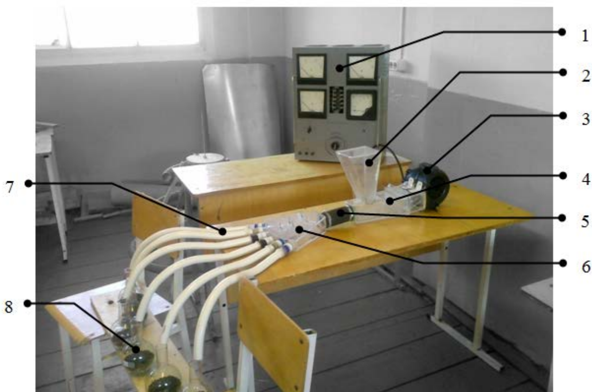
Рисунок 2 – Лабораторная установка пневматического горизонтального распределителя семян с подвижными перегородками:
