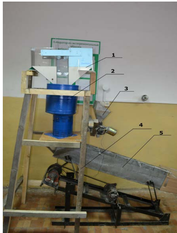
Рис. 1 Малогабаритный комбикормовый агрегат: 1 – многокомпонентный бункерный дозатор; 2 – бытовой измельчитель зерна; 3 – дозатор жмыха; 4 – рама; 5 – вибрационный смеситель.
